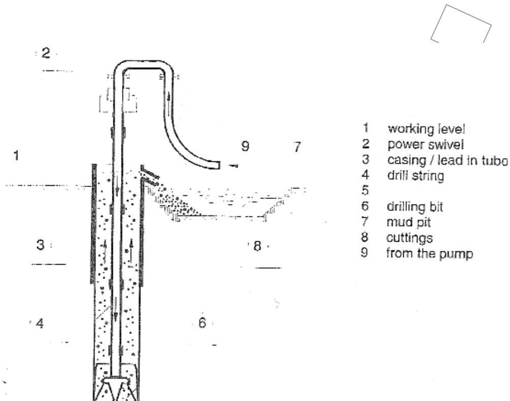
Σχήμα 6α – Σύστημα συνεχούς διάτρησης – Φάση εισπίεσης
